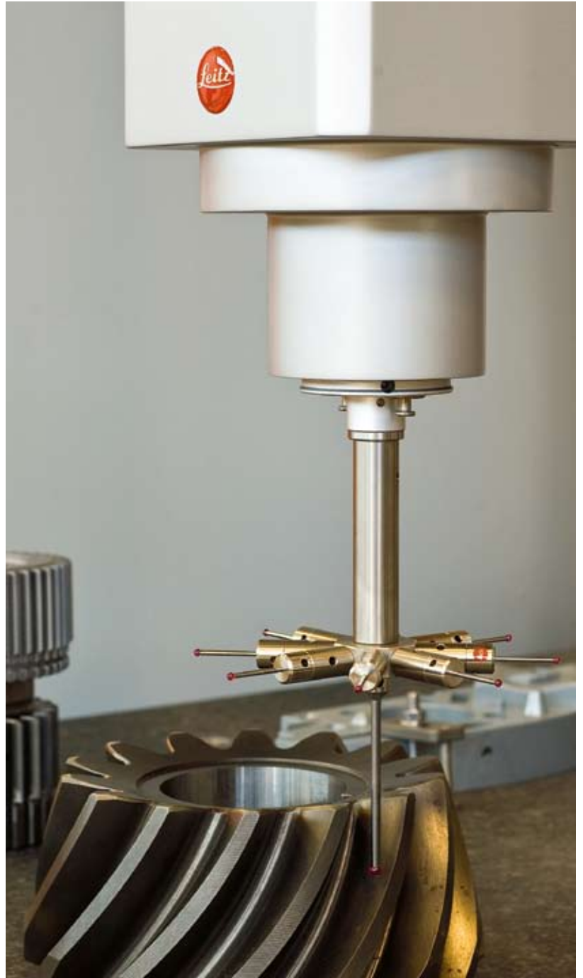
Leitz PMM-C 12 107 mäter specialgeometriska former med hjälp av avancerad teknik och mätspetsar av industrirubin.
